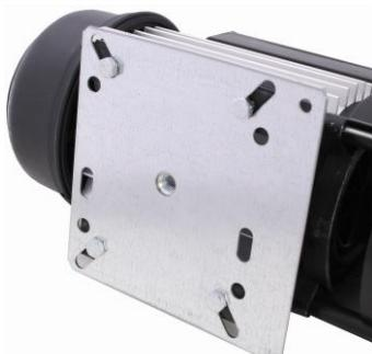
2. Um die Pumpe mit der Montageplatte anzubringen, schrauben Sie einfach einen M10-Gewindebolzen oder -Gewindestange in die in der Platte integrierte Mutter.
